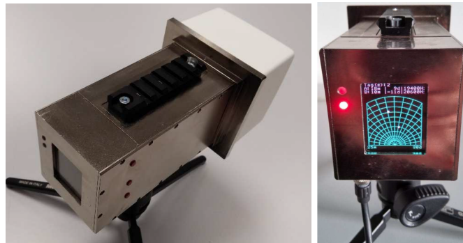
FIGURE 3 – Le radar conçu équipé d'un écran OLED.
